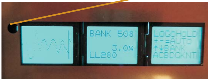
Kuva 7. AK30 näyttö jossa on trendikäyrä sekä muuta tietoa mittauksesta, BANKS-moodi, sininen väri. Valikko on käytettävissä samaan aikaan.
