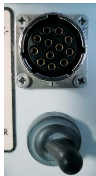
Kuva 2. Virtakytkin sekä kaapeliliitin mallille AK40, 12-napainen ITT Cannon
