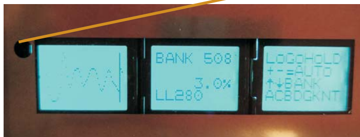
Abbildung 7. AK30/MK30 Display mit Trendkurve und detaillierten Informationen, in Blau im BANKEN-Modus. Das Menü-System ist gleichzeitig verfügbar.
