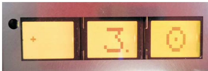
Abbildung 6. AK30/MK30 Display mit großen Ziffern in Gelb im TABELLEN-Modus
