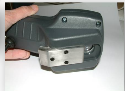
Standardaufsatz für Messung laufender Bahnen, Bögen und Tamboure
